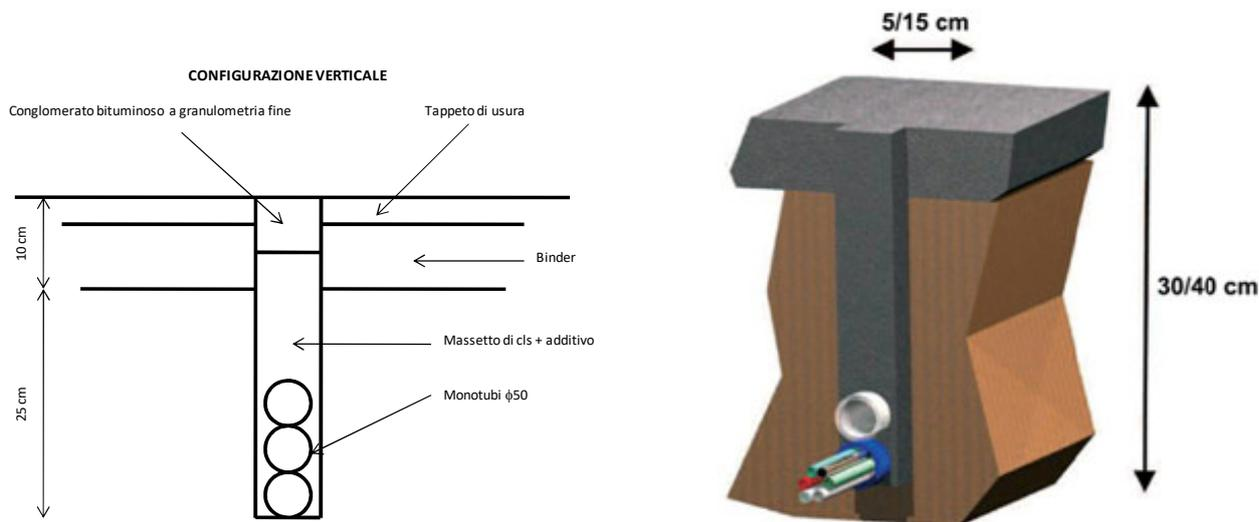
Figura 05 - Sezione tipo scavo in trincea su sede stradale
