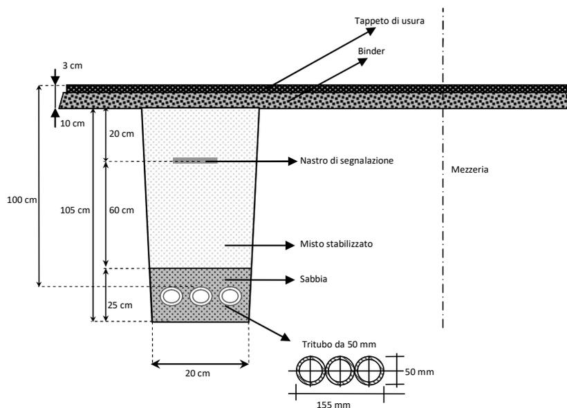
Figura 06 - Sezione tipo scavo in trincea su sede stradale
