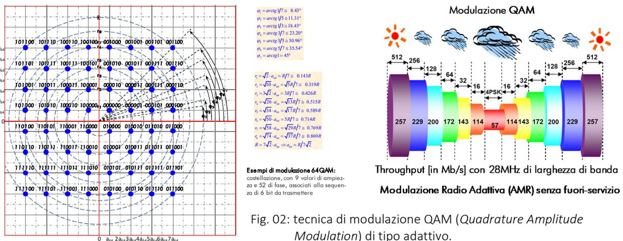
Fig. 02: tecnica di modulazione QAM (*Quadrature Amplitude Modulation*) di tipo adattivo.
