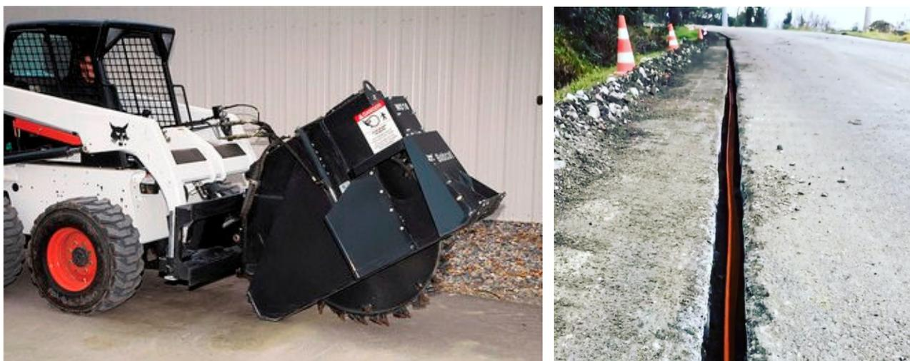
Figura 07 – Macchina operatrice per esecuzione di minitrincea
