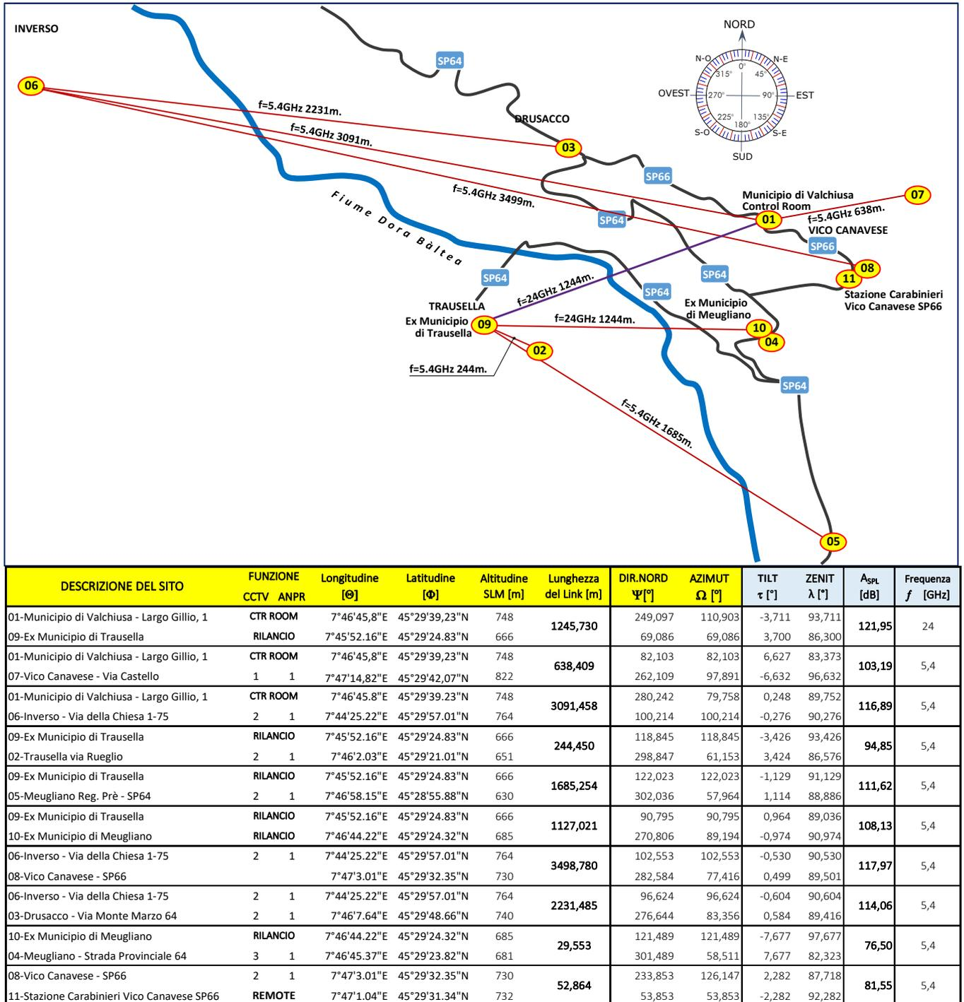
Fig. 03: Schema della rete radio di trasporto a larga banda e tabella dei parametri funzionali dei siti
