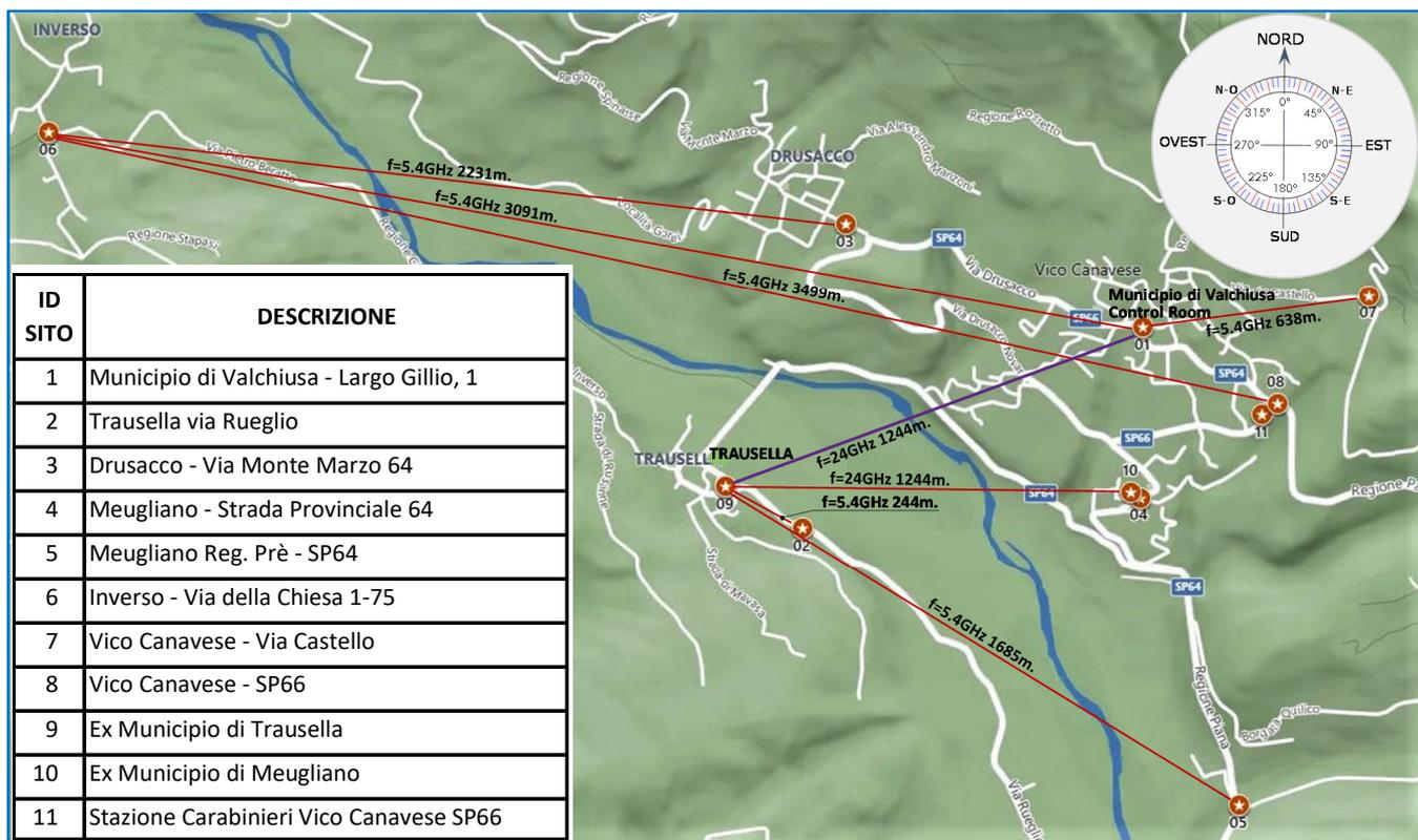
Fig. 01: architettura della rete radio di trasporto al SVU ANPR e CCTV del comune di Valchiusa
