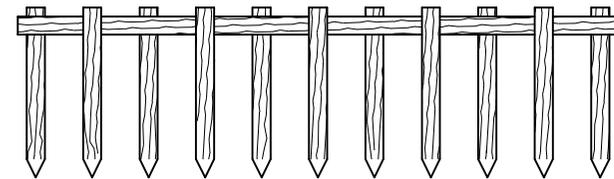
Prospetto tipo, palificata a traversi alternati
