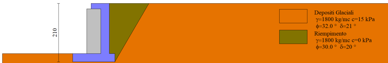
Figura 23 Estratto dal software di calcolo MAX 16.0 – Geometria di modellazione in sezione, condizione stratigrafica e di carico
