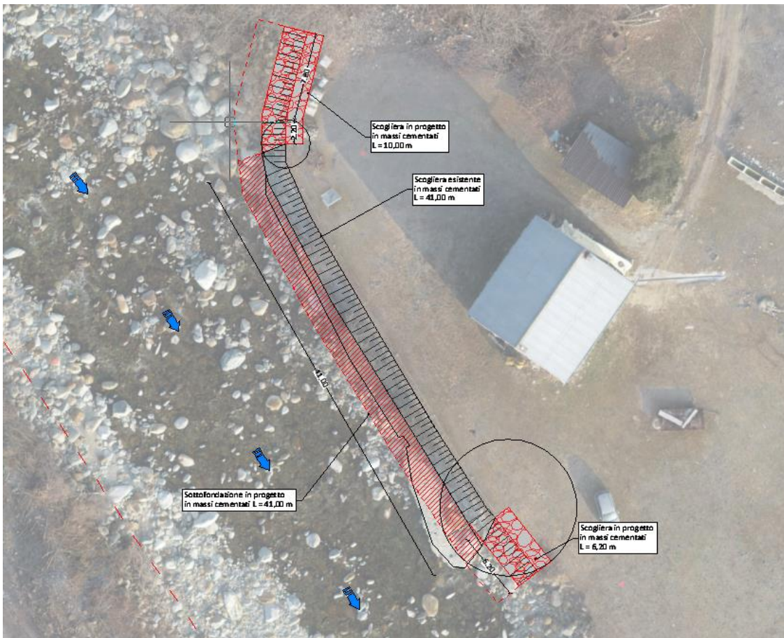
Figura 4: Tratto spondale in sinistra idraulica oggetto di intervento, in rosso scogliera e sottofondazione
